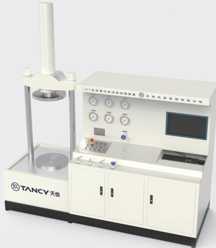
LMT 型流量计多功能试验装置（以下简称“装置”），主要由液压系统、打压系统、压力比对系统、控制系统、夹紧工作台系统等部分组成，测试过程与结果，符合相关规定和要求，适用于各种流量计的密封试验、超声流量计干标试验、强度试验、流量计压力传感器比对试验等。
