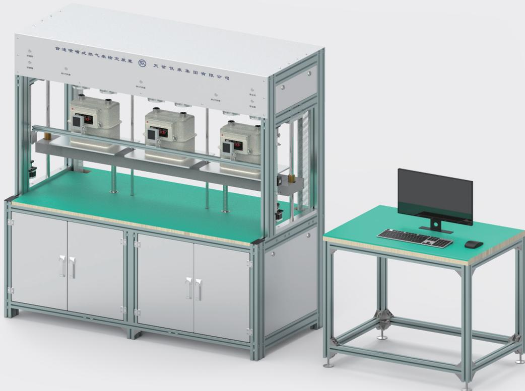
LPH 型音速喷嘴式燃气表检定装置（以下简称“装置”），选用临界流文丘里喷嘴作为流量标准器，采用比较法原理对燃气表进行检定或测试。依据国家相关计量技术规范，该装置可对各类燃气表进行检定、校准或测试。
