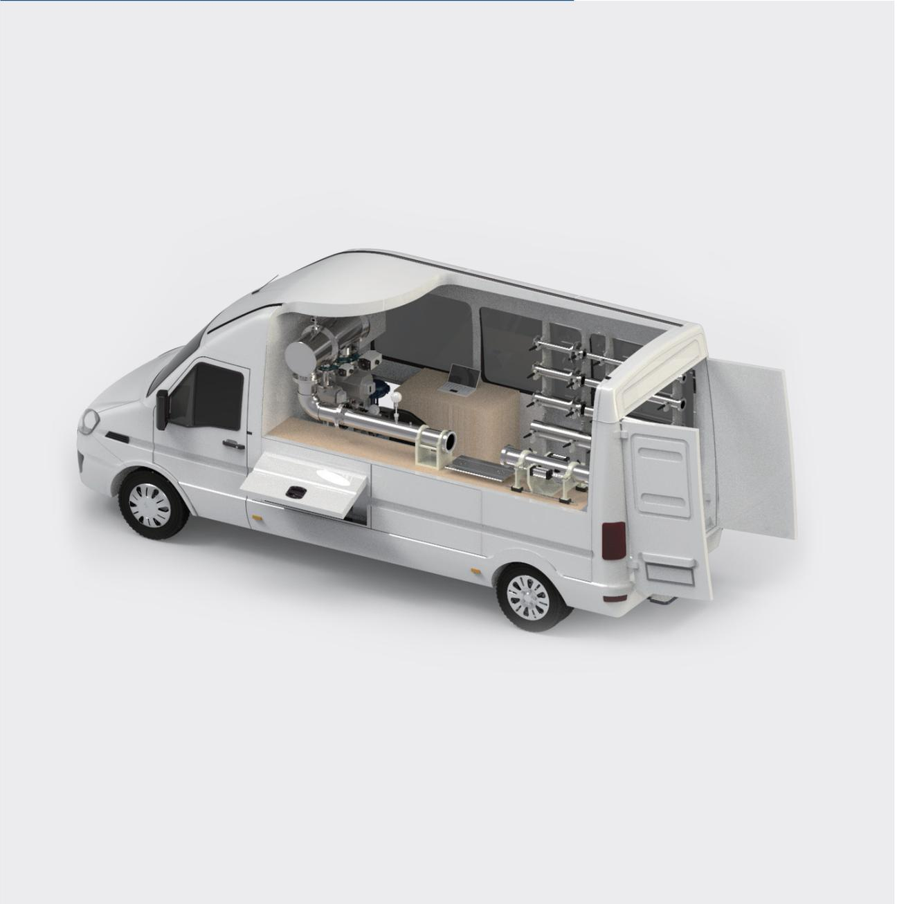
TTSD 型车载式气体流量标准装置（以下简称“装置”），选用高精度标准流量计或临界流文丘里喷嘴作为流量标准器。依据国家相关计量技术规范，该装置可对速度式流量计、容积式流量计、差压式流量计、质量流量计等多种流量计进行检定、校准或测试。
