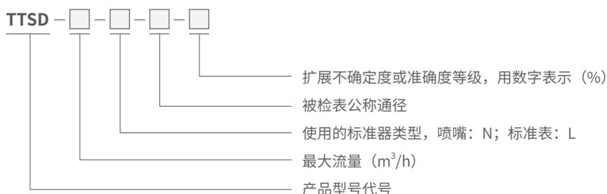
流量范围 1m<sup>3</sup>/h ~ 1000m<sup>3</sup>/h，空气介质，负压法，标准表作标准器，被检表公称口径为 DN25/50/80/100，扩展不确定度  $U_r=0.33$  ( $k=2$ )。代号表示为：
